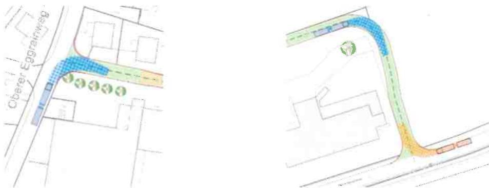
Die weitere Überprüfung mit Einbezug der Faktoren, wie der Anhaltesichtweiten / Ausweichstellen (VSS-Norm 640 090b), ergibt die nachfolgende Strassengeometrie.
